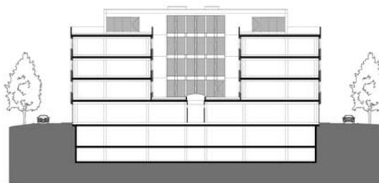
orientation, mettent en évidence la tête de la composition. Les deux ailes présentent un marquage fortement horizontal, obtenu par traitement des contrecœurs en béton préfabriqué de couleur noire, minimisant les divisions verticales multiples dues à la séparation des bureaux. Pour la tête, encadrée par deux voiles en béton brut de décoffrage, un treillis à mailles métalliques se déploie sur toute la façade sud, offrant une protection solaire efficace et contribuant à l'image forte du bâtiment.
